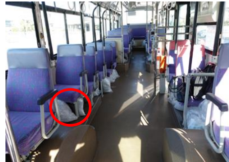
写真 3 - 2 ウェイトの設置状況
