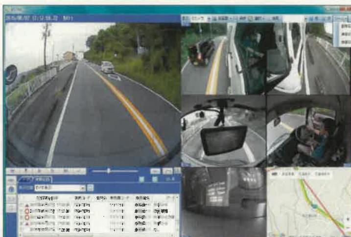
図 ドライブレコーダー解析ソフトの例
